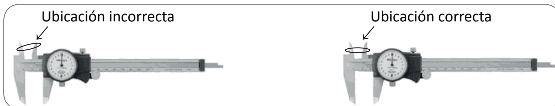
Figura 12. Toma de medidas internas con calibrador Pie de rey con comparador de carátula
