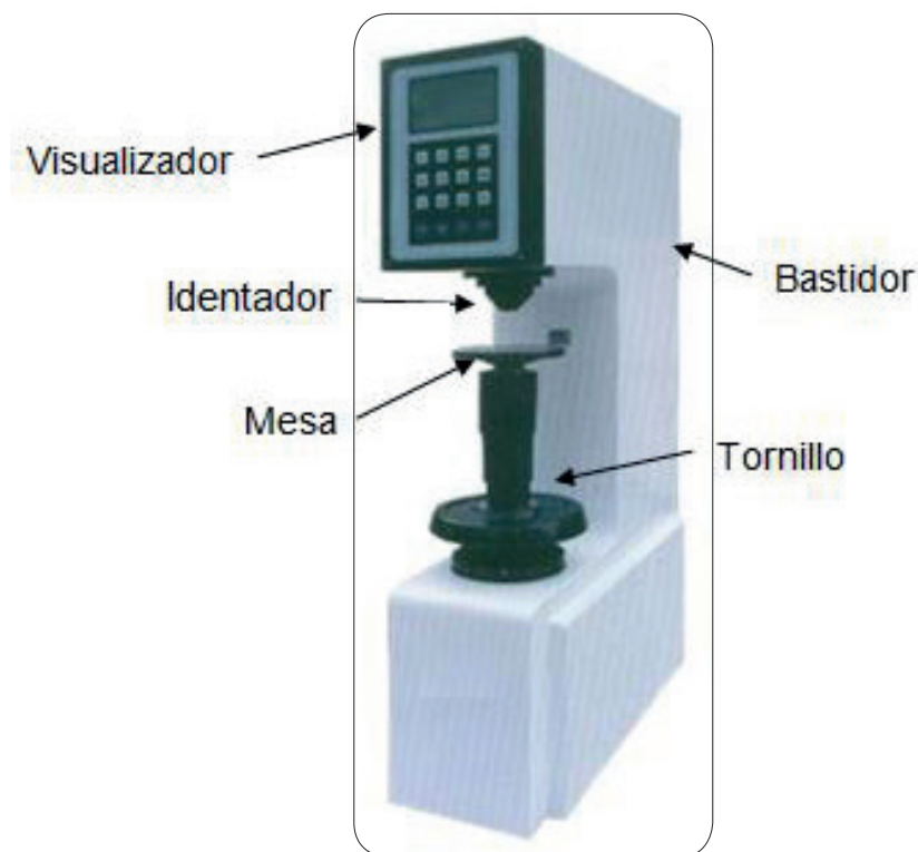
Figura 15. Partes del Durómetro
