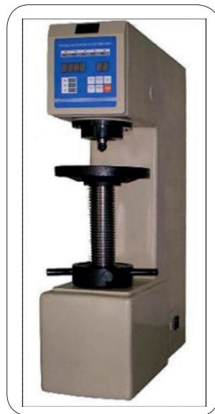
Figura 7. Durómetro (para pruebas destructivas)
