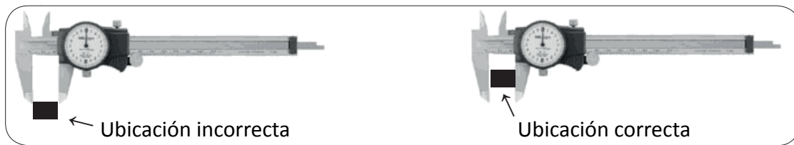
Figura 11. Toma de medidas exteriores con calibrador Pie de rey con comparador de carátula
