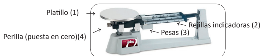
Figura 14. Partes de la Balanza mecánica triple brazo
