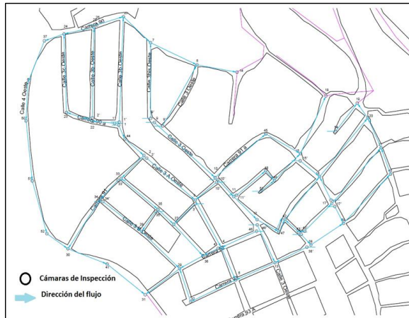
Imagen 2. Red de Alcantarillado
