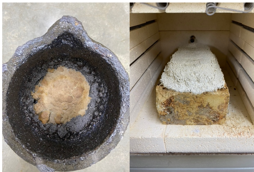
Fig. 15. Imágenes de comparación entre alúmina-espínela obtenida con el crisol vs alúmina-espínela obtenida con ladrillos refractarios.
