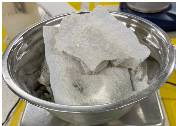
Fig. 16. Imagen de la alúmina-espínela obtenida después del proceso de calcinación de escoria de aluminio.
