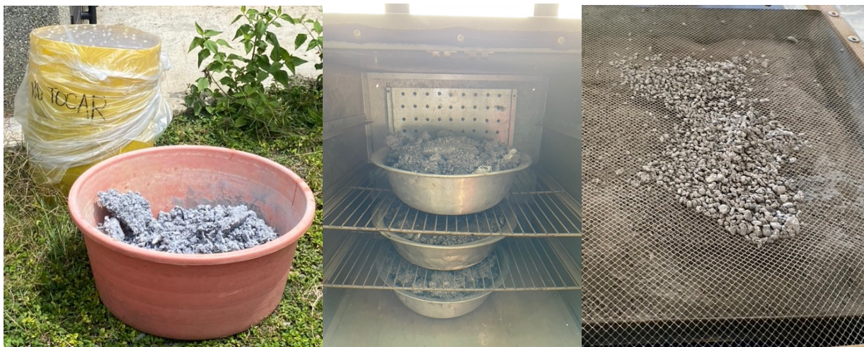
Fig. 14. Imágenes del proceso de apagado, secado a 100 °C y zarandeado.
