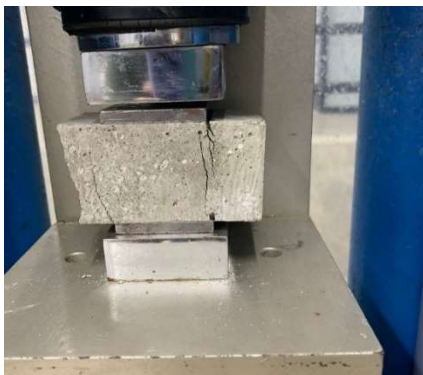
Figura 20 Mitades de vigas ensayadas a compresión, Fuente: Propia
