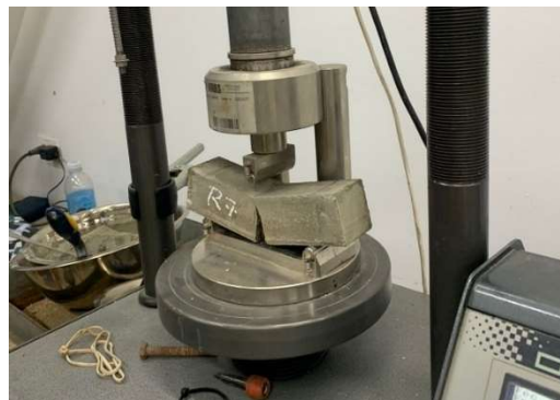
Figura 19 Viga de mortero 16x4x4 Cm fallada, Fuente: Propia
