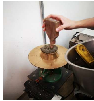
(b) Proceso de compactación
