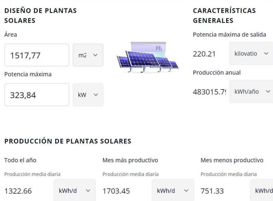
Figura 29. Simulación de planta solar fotovoltaica [43]
