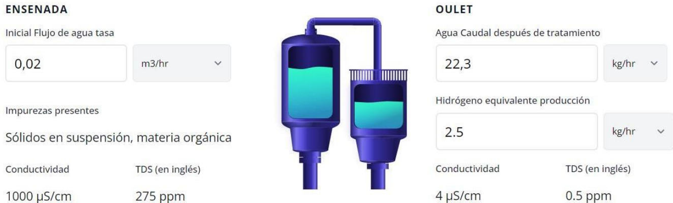
Figura 32. Simulación de unidad de ósmosis inversa [43]
