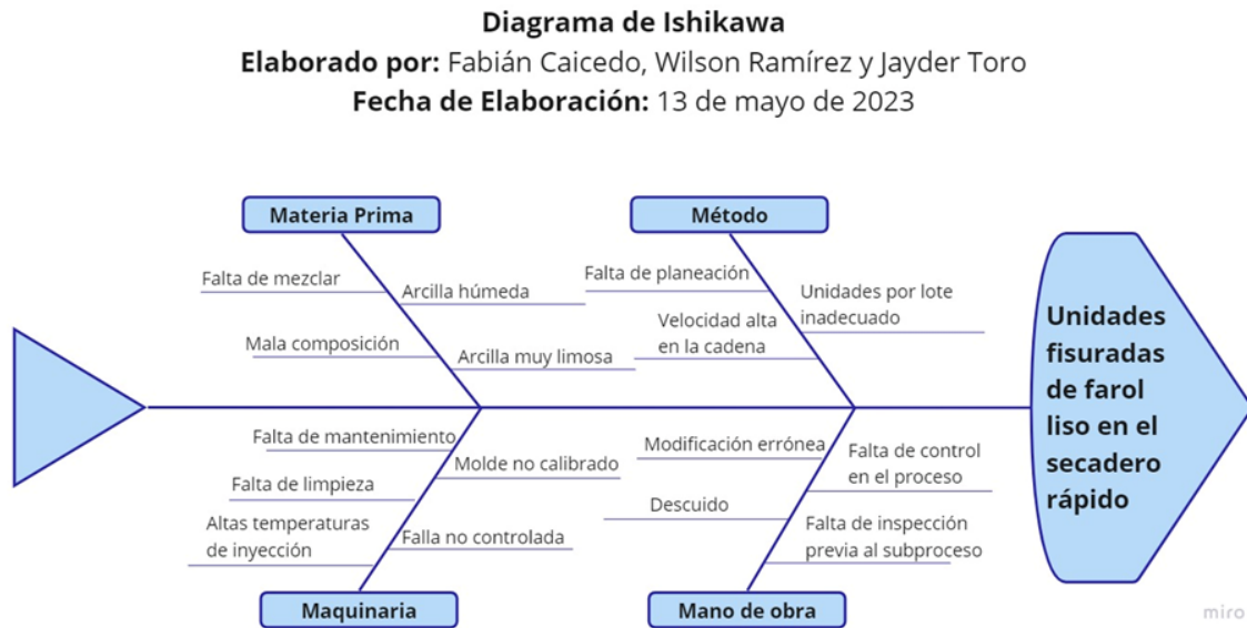
Fig. 10. Diagrama de Ishikawa para unidades de farol liso en el secadero rápido.
