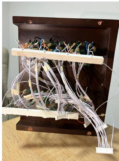
Figura 4.11: Organización interna del cableado de los sensores FSR hacia los conectores de la PCB de adquisición.
