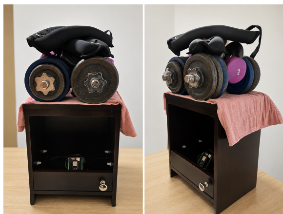
(a) Prueba de carga sobre la estructura del podoscopio.
