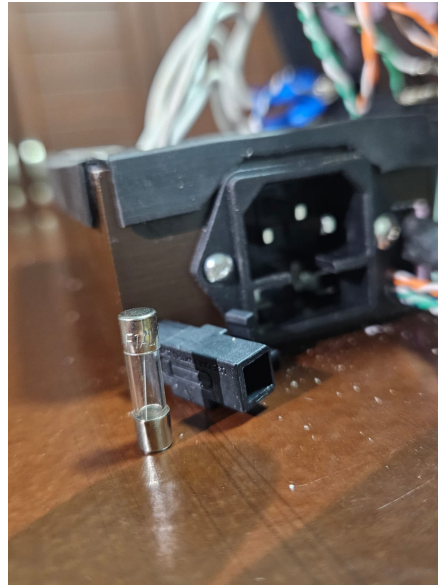
Figura 5.6: Verificación del fusible de 0,5 A instalado en el conector de entrada de alimentación del prototipo.
