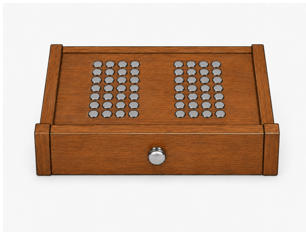
Figura 4.6: Ubicación de la cama de sensores sobre el cajón inferior instrumentado.
