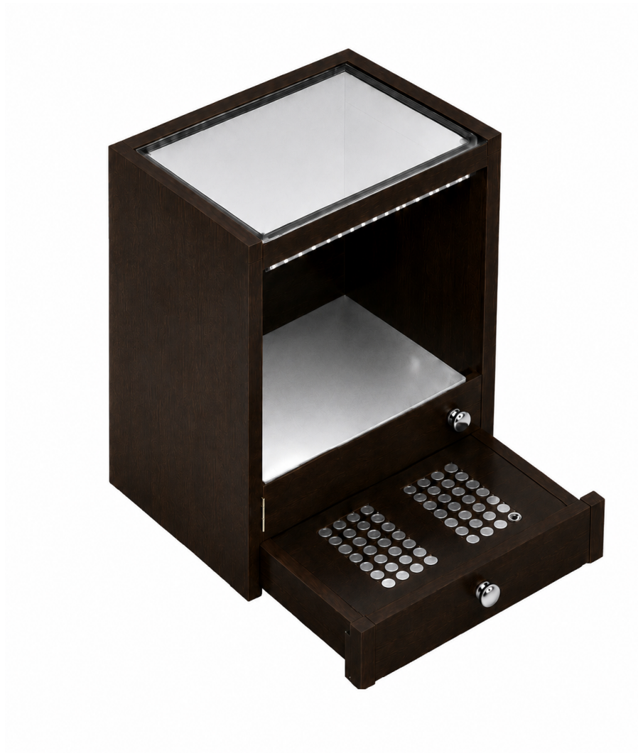
Figura 6.1: Prototipo final de la plataforma baropodométrica infantil completamente ensamblado.
