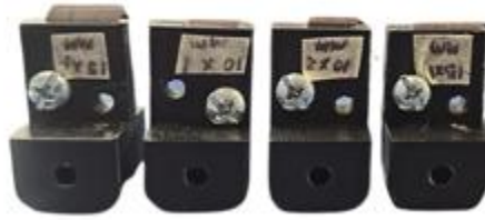
Ilustración 13: Impresión 3D del boceto final del mecanismo de corte
