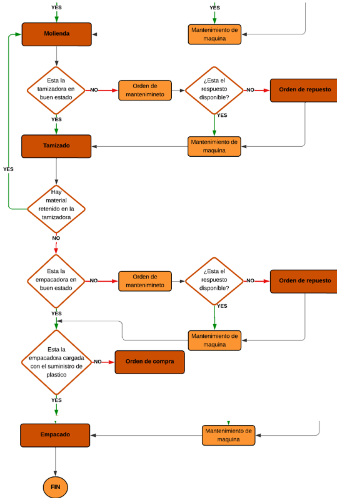
Figura 12. Diagrama de flujo del proceso de producción de harina de chontaduro [28].
