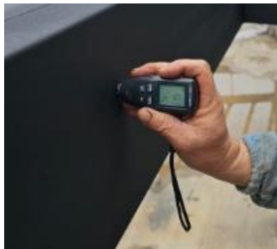
Figura 8. Otros parámetros de inspección – Espesores de pintura
