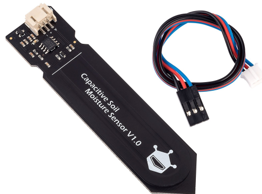
Figura 6.4: Sensor de humedad de suelo SEN0193. Fuente: Zamux Electrónica.
