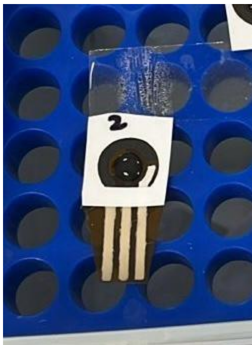
Figura 6.3: Depósito de solución de BSA sobre el electrodo de trabajo durante la etapa de bloqueo de superficie.
