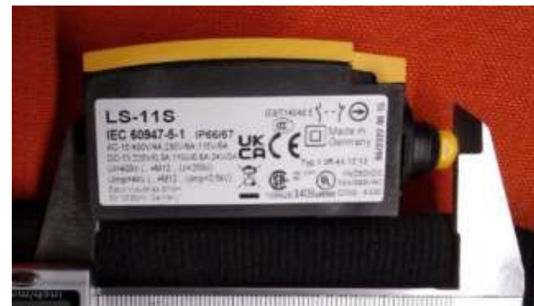
Figura 49. Switch para detectar el estado de la puerta. Fuente: Elaboración propia.
