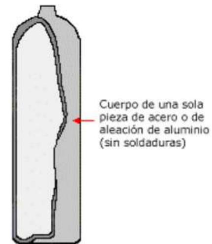
Figura 1. Cilindro sin costuras. Fuente: [5]
