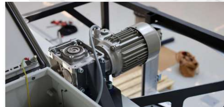
Figura 50. Instalación del motor y la caja reductora de velocidades. Fuente: Elaboración propia.
