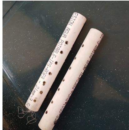
Figura 3.16: Filtro de desagüe versión 1
