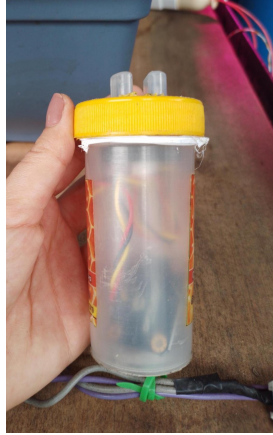
Figura 3.42: Sensor de turbidez con adecuación
