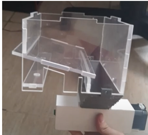
Figura 3.67: Construcción de la primera versión de dosificador
