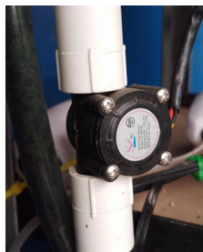
Figura 3.45: Sensor de caudal
