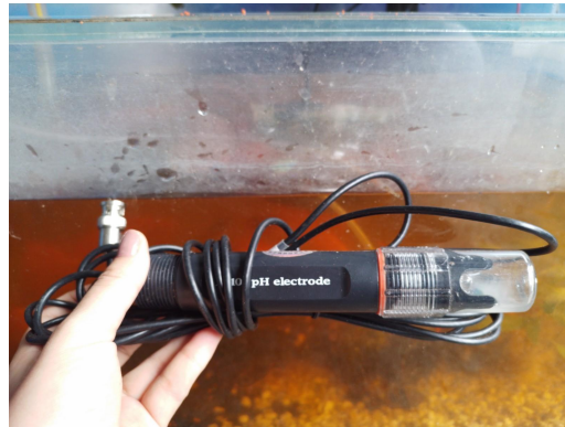
Figura 3.40: Sensor de pH
