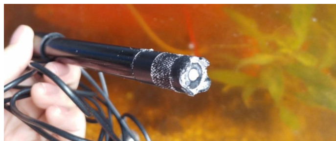
Figura 3.41: Sensor de oxígeno disuelto
