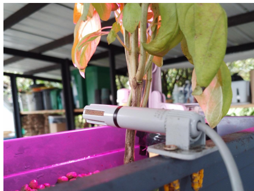
Figura 3.39: Ubicación esperada del sensor de temperatura y humedad para cada nivel
