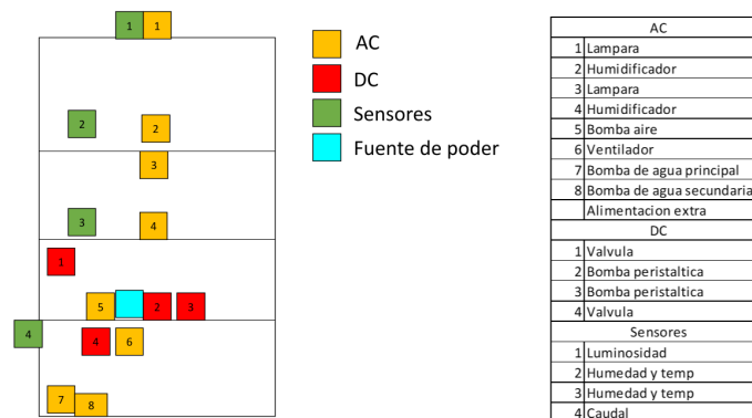
Figura 3.57: Vista frontal 2D de los puntos de conexión en la estructura física
