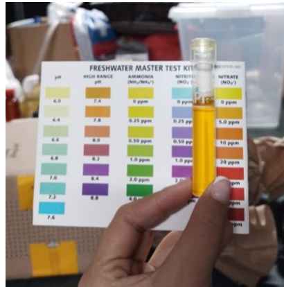
Figura 3.92: Ejemplo de resultado obtenido con el kit medidor de variables de calidad de agua
