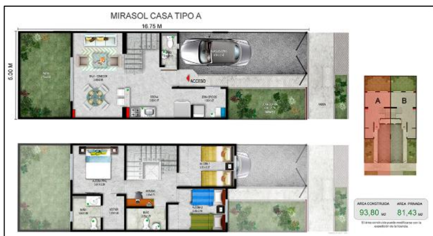
Figura 13. Distribución arquitectónica vivienda tipo Mirasol II.
