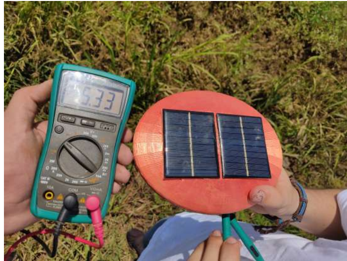
Figura 4.2: Prueba de paneles solares en ambiente real
