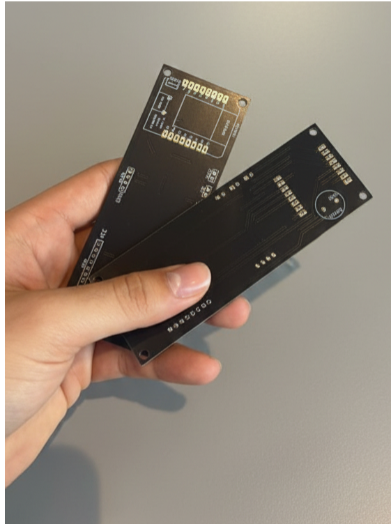
Figura 6.4: PCB en su versión inicial, tal como se recibió del servicio de fabricación.
