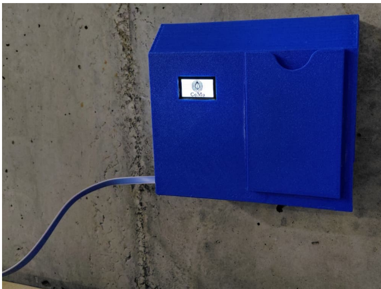
Figura 6.8: Nodo RFID ensamblado en su encapsulado final (fotografía real).
