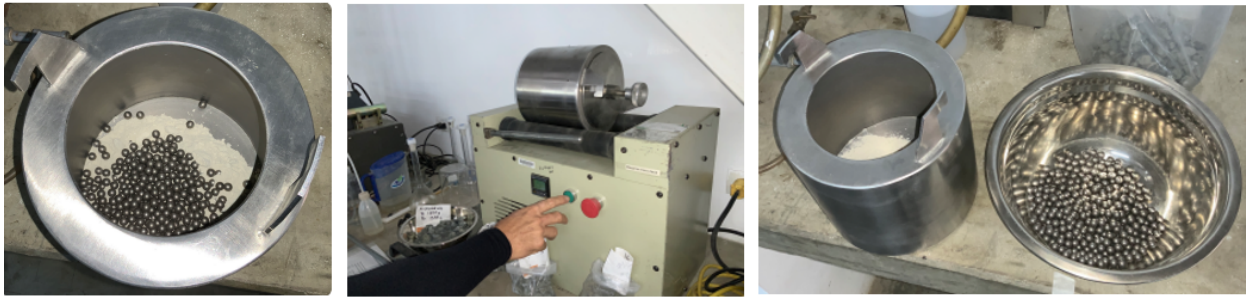
Fig. 4.8: Experimento con micro-deval para desaglomerar la escoria después de la calcinación.
