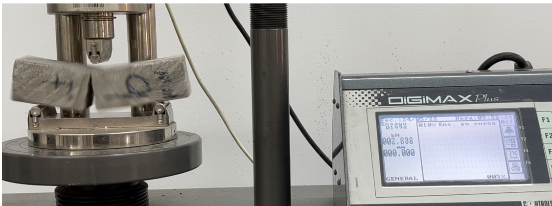
Fig. 4.21: Máquina universal de ensayos (flexión en vigas).
