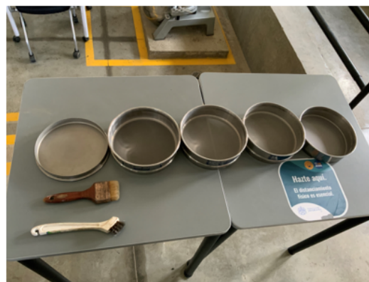
Fig. 4.4: Tamices utilizados para la separación granulométrica de la escoria de aluminio.
