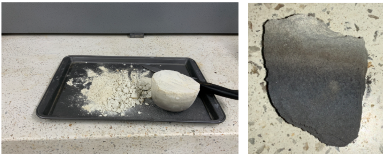
Fig. 4.7: Aglomeraciones de T1 después de la calcinación.
