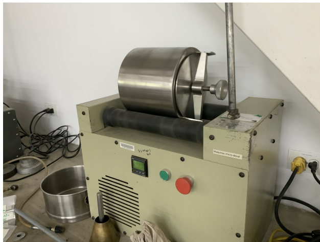
Fig. 4.10: Pulverización de las muestras calcinadas en el micro-deval.
