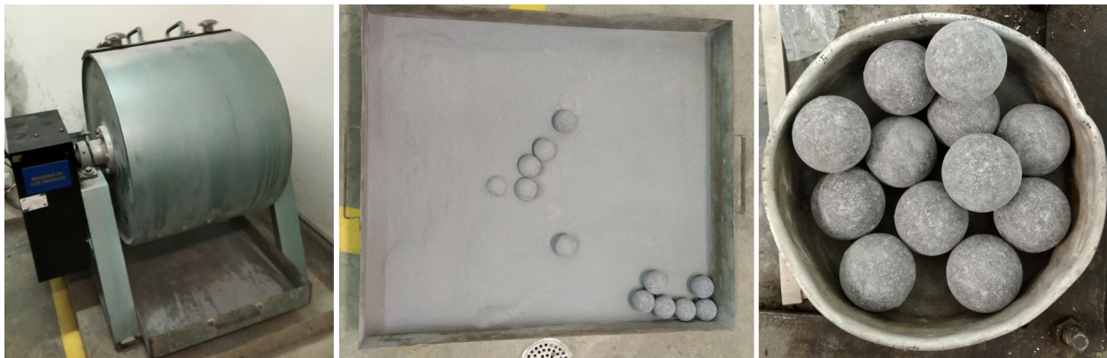
Fig. 4.3: Máquina de los ángeles, escoria resultante de la molienda y las 12 bolas de hierro.
