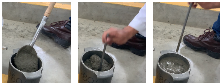
Fig. 4.16: Ensayo de densificación de la mezcla.
