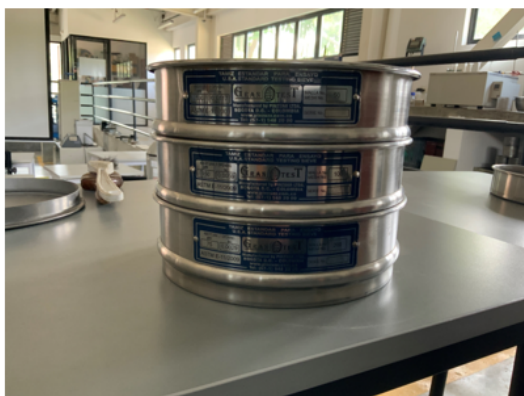
Fig. 4.4: Tamices utilizados para la separación granulométrica de la escoria de aluminio.
