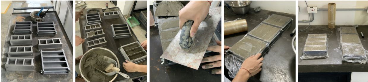
Fig. 4.18: Formaletas, compactación, enrasado, cubierta en papel film y fraguado.
