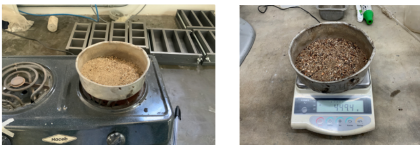
Fig. 4.12: Proceso de determinación de humedad de la arena para la mezcla.
