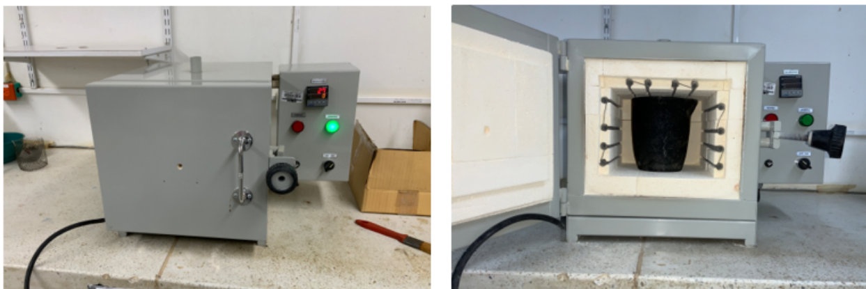
Fig. 4.6: Mufla Terrigeno D8 utilizada para el proceso de calcinación con crisol de grafito.
