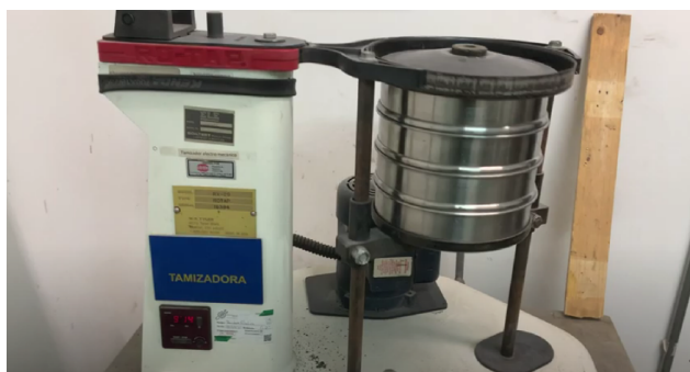
Fig. 4.5: Tamizadora utilizada para la separación granulométrica de la escoria de aluminio.
