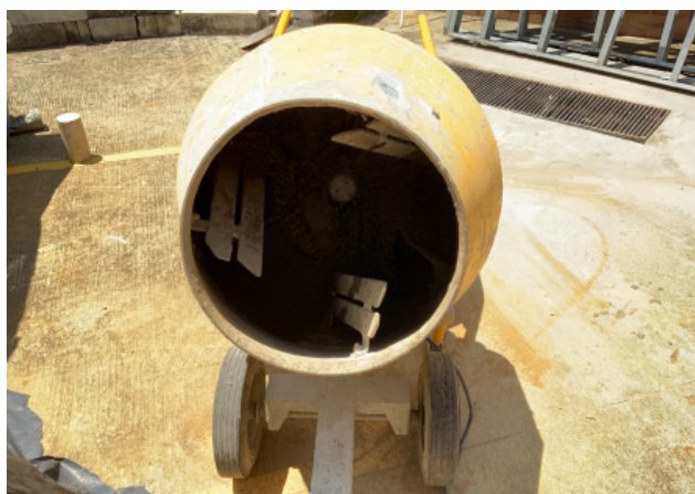
Fig. 4.14: Máquina mezcladora utilizada para humedecer la arena.
