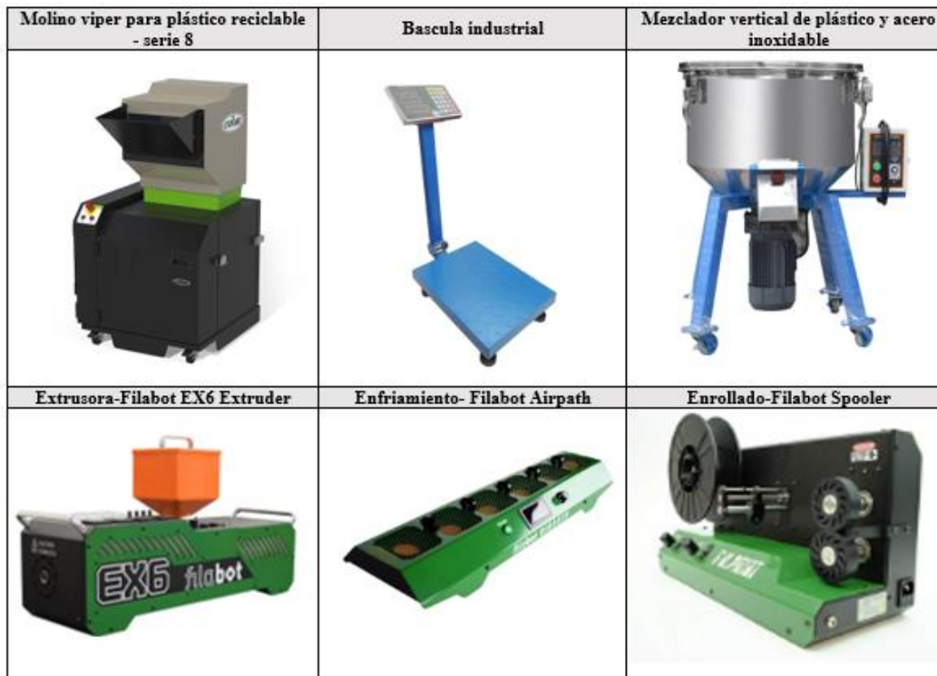
Fig. 26. Equipos necesarios en la fabricación de filamento para impresión 3D [33] [34] [35] [36] [37] [38].
