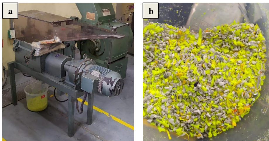
Fig. 16. a) Molino de golpe (Ubicado en el Centro ASTIN-SENA), b) PLA reciclado posteriormente de ser triturado.
