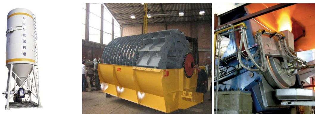
Fig. 24. a) Silo para almacenamiento [149], b) Noria para lavado de escoria [150] y c) Horno rotativo basculante [151]
