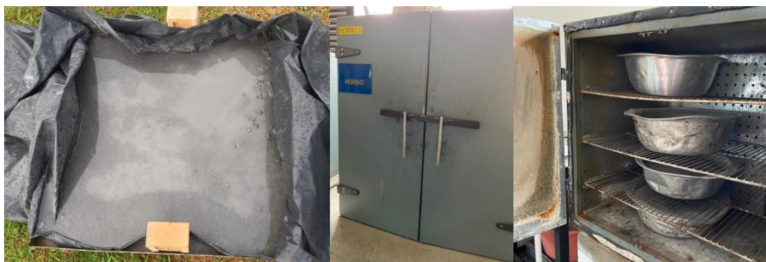
Fig. 13. a) Proceso de lavado de escoria de aluminio y b) secado de la escoria lavada
