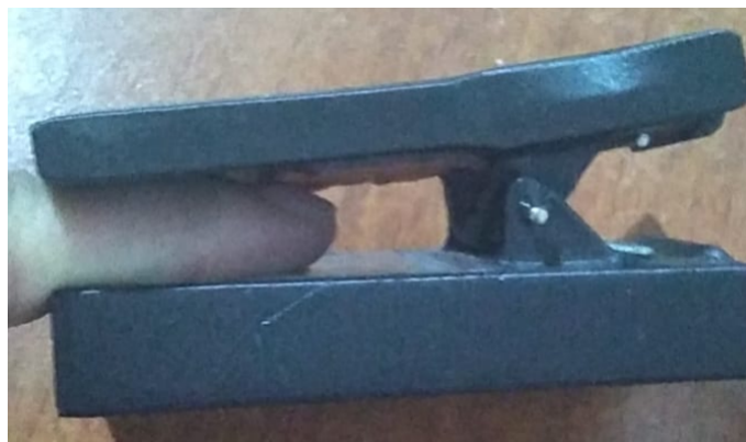
Figura 7.1: Hardware para la medición de frecuencia cardiaca
