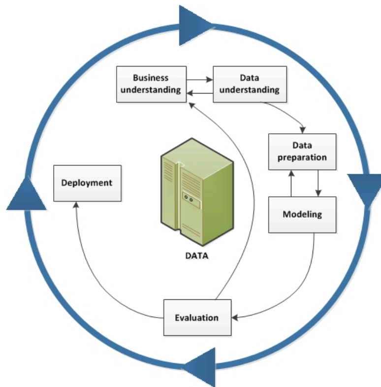
Figura 1. Ciclo de vida de minería de datos con la metodología CRISP-DM. Fuente: [16]
