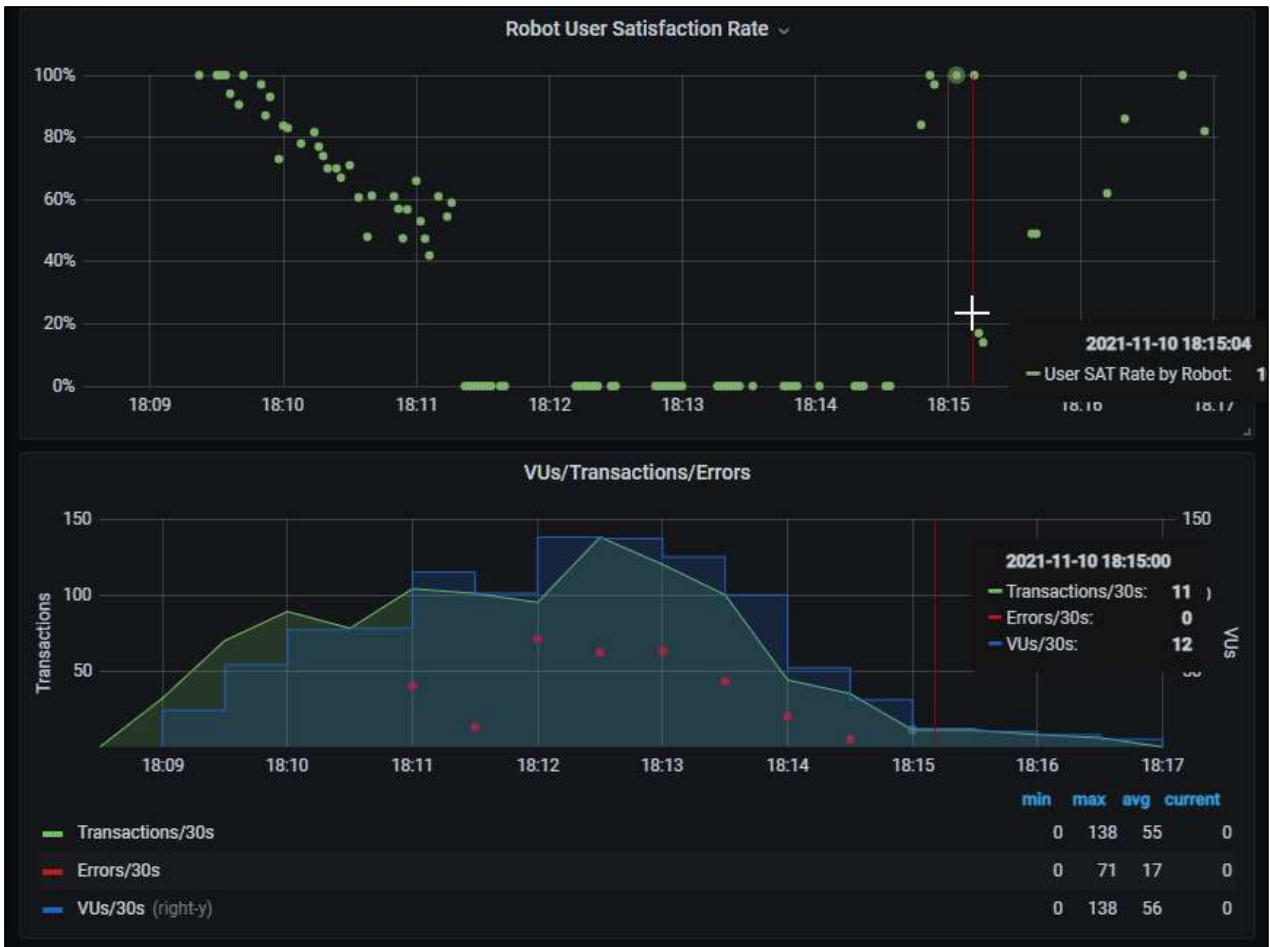
Imagen 58. Iteración 04 - Porcentaje de satisfacción de usuario por robot, Transacciones vs Usuarios vs Errores
