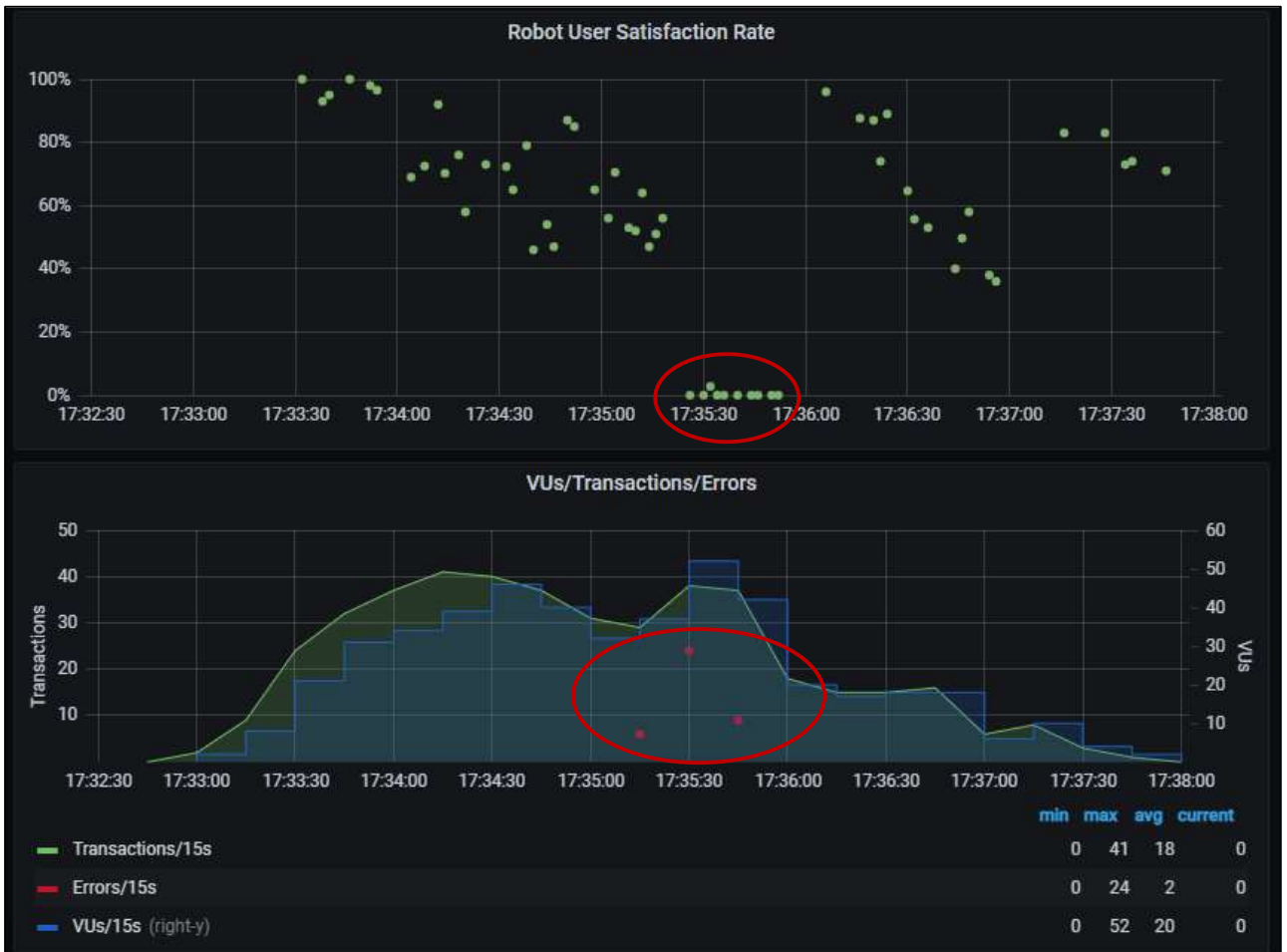
Imagen 52. Iteración 02 - Porcentaje de satisfacción de usuario por robot, Transacciones vs Usuarios vs errores
