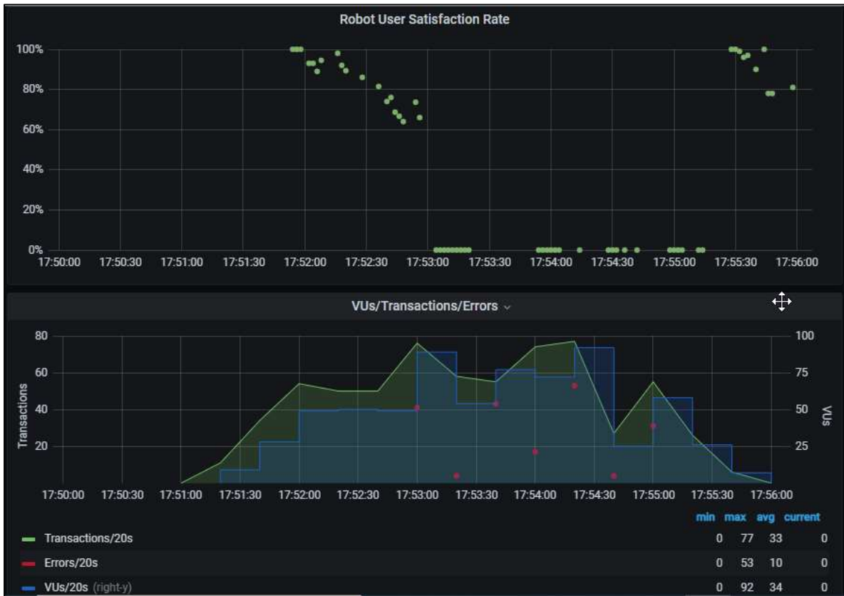
Imagen 55. Iteración 03 - Porcentaje de satisfacción de usuario por robot, Transacciones vs Usuarios vs Errores
