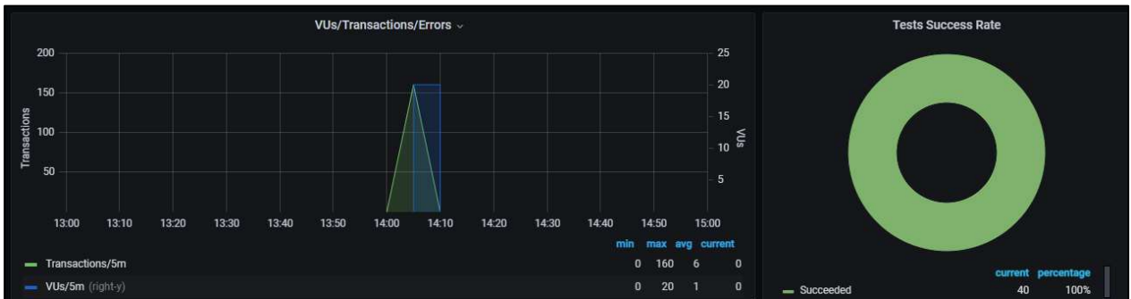
Imagen 50. Iteración 01 - Cantidad de transacciones vs Usuarios simultáneos vs Cantidad de errores
