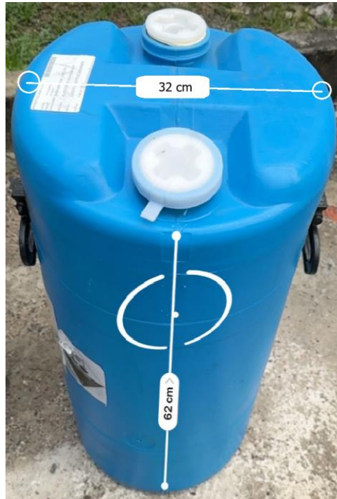
Figura 47. Contenedor del agua con sus respectivas medidas [60].
