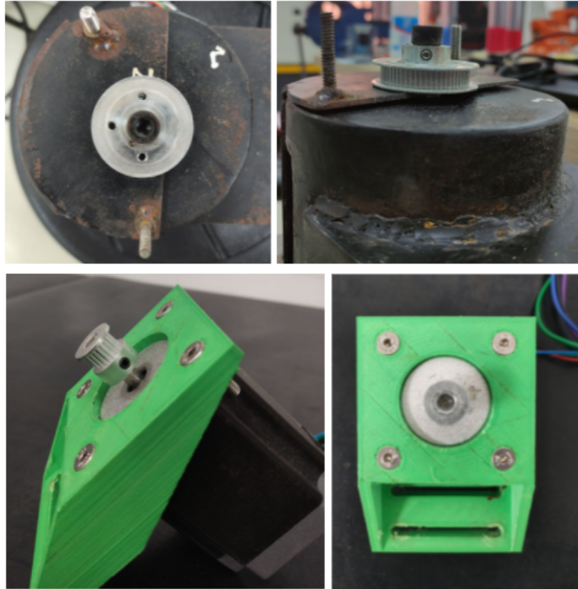
Figura 4.10: Motor instalado en la base diseñada
