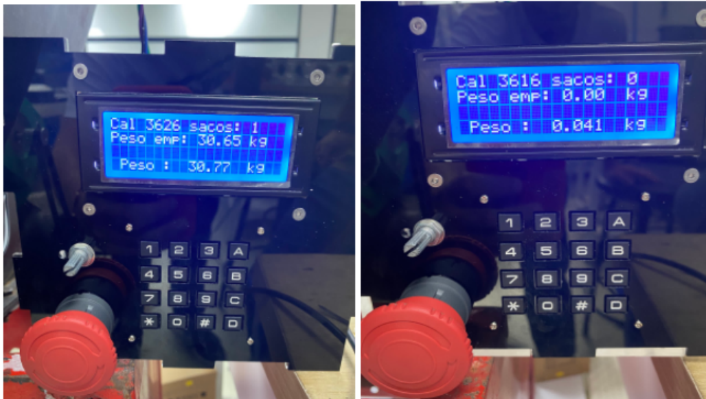
Figura 5.12: Conteo de sacos y material utilizado mostrado por pantalla
