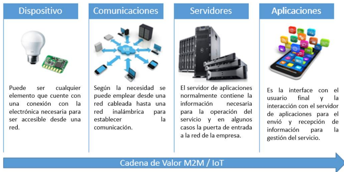
Ilustración 2 Componentes de la cadena de valor soluciones M2M e IoT. Fuente Propia
