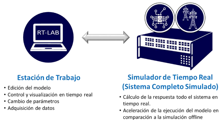
Figura 9. Esquema de Model In the Loop.
