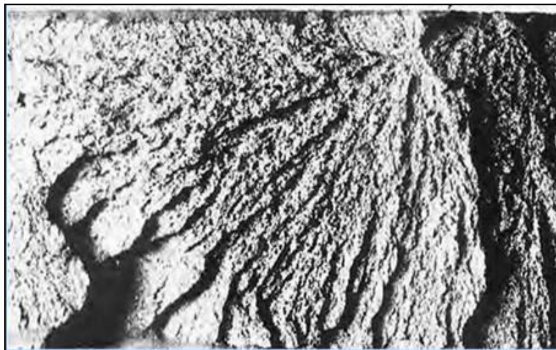
Fig. 11 - Fractura frágil de un material metálico que presenta patrón de Chevron en su superficie [14]
