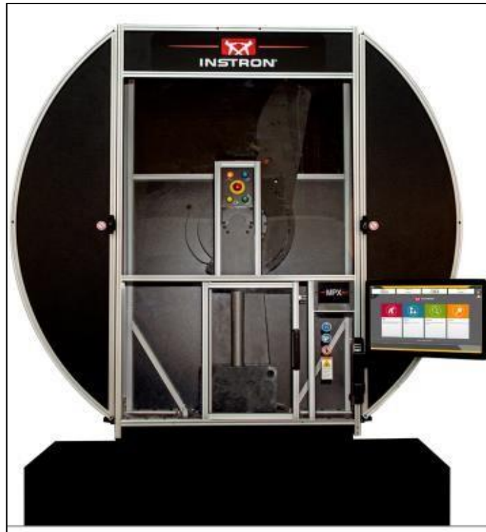
Fig. 23 - Máquina de ensayos de impactos mecánicos (Modelo Instron MPX) [33].
