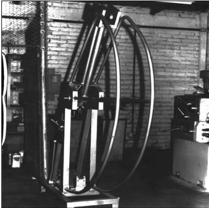
Fig. 24 - Modelo de máquina de pruebas de impactos mecánicos elaborado por L. Domínguez [25].
