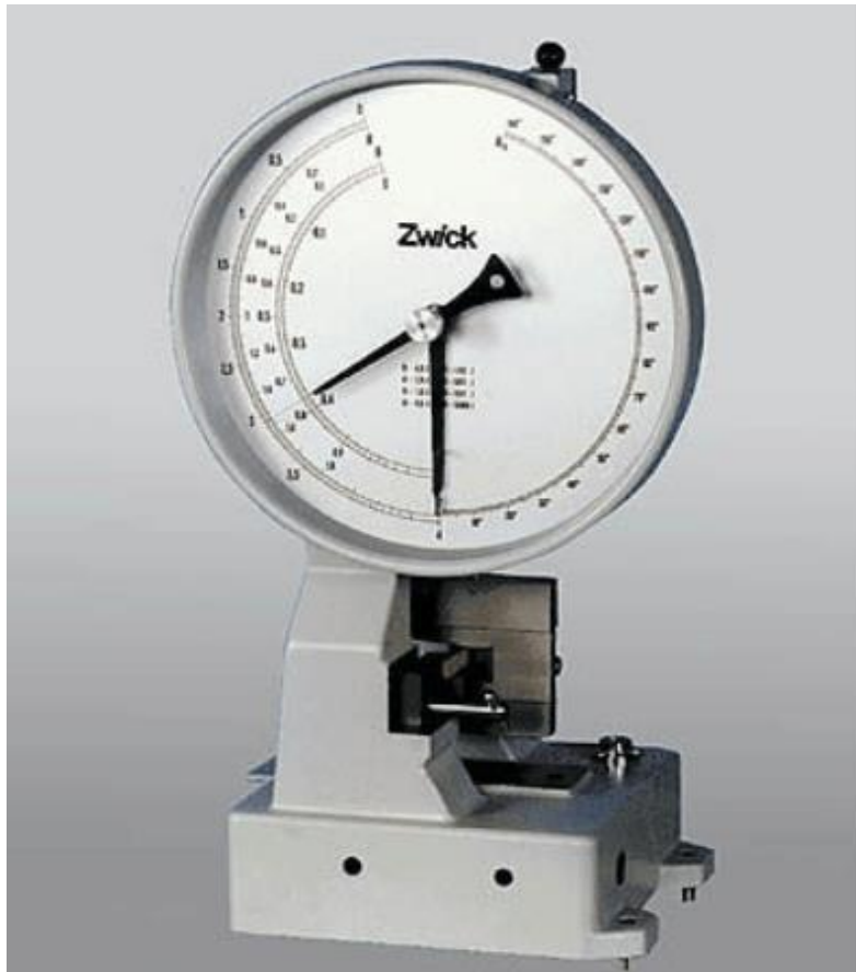
Fig. 21 - Máquina de ensayos de impactos mecánicos (Modelo Zwick 5102) [16].
