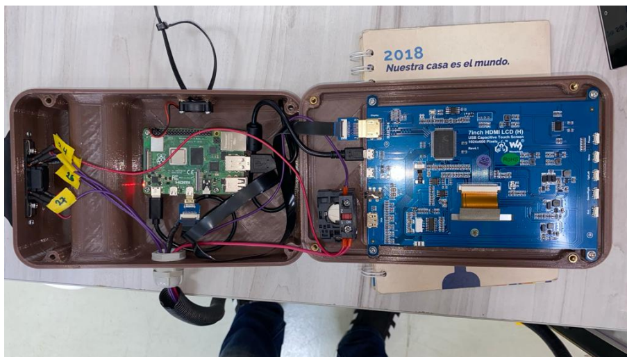
Figura C.7: Estructura con componentes del teach pendant
