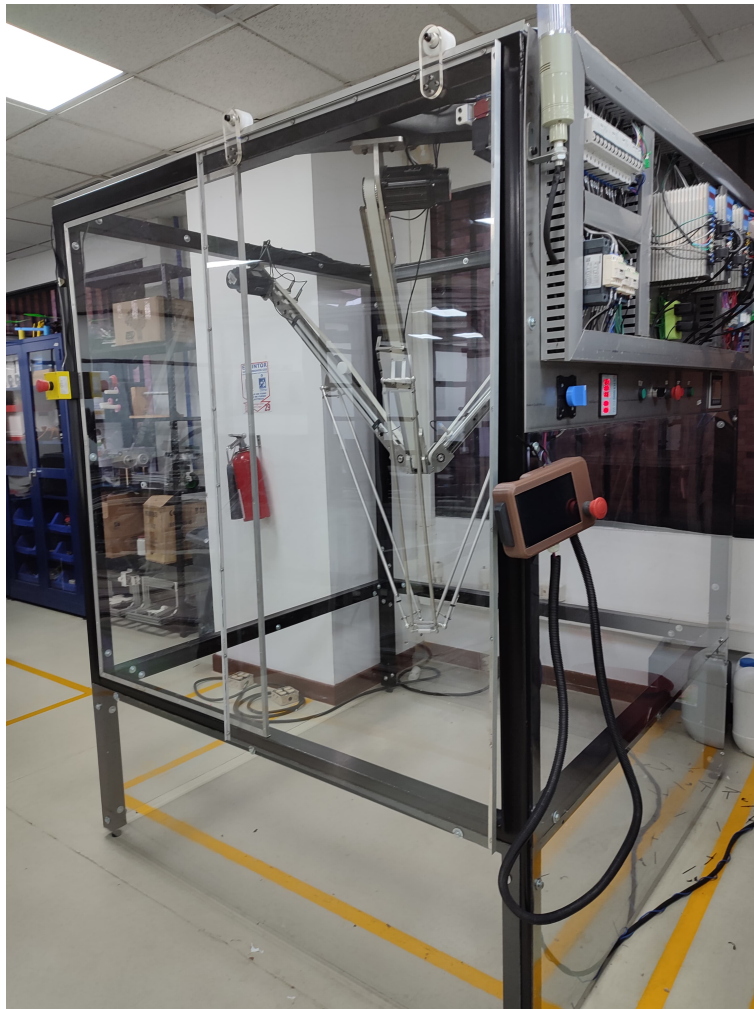
Figura C.1: Celda robótica con las guardas y puerta implementadas (vista 1)
