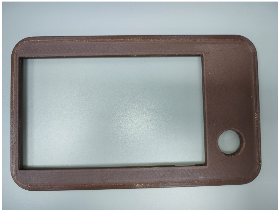
Figura C.6: Tapa para la estructura del teach pendant
