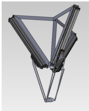
Figura 5.1: Configuración robot delta lineal tipo Keops o inclinado
