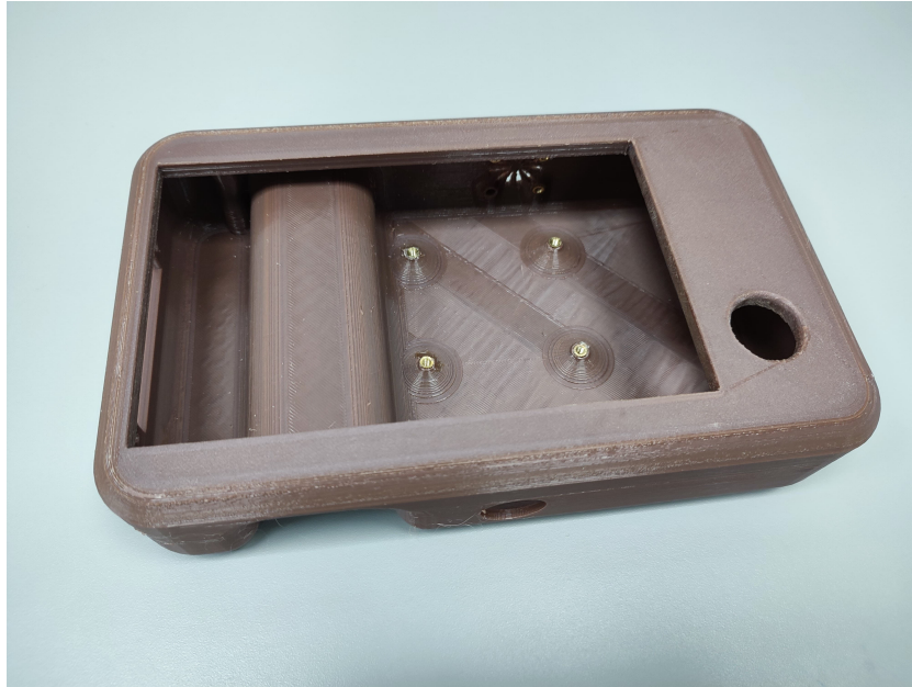
Figura C.4: Estructura ensamblada del teach pendant
