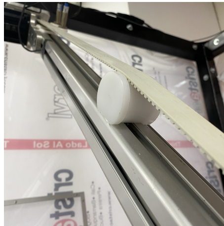
Figura 6.1: Patín de tensión instalado en la mitad de los rieles
