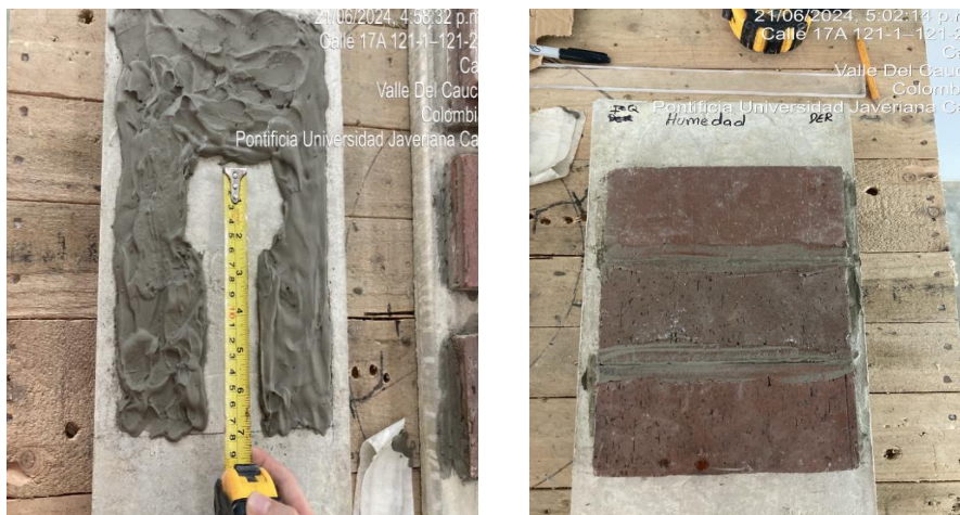
Figura 21. Construcción de la placa P3 (placa con humedades): a) delimitación de la zona b) pega de fachaleta
