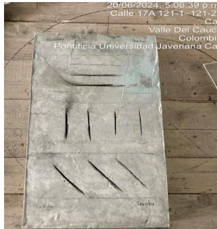
Figura 19. Construcción de la placa P2 (inducción de fisuras): a) medición de profundidad b) fisuras finalizadas
