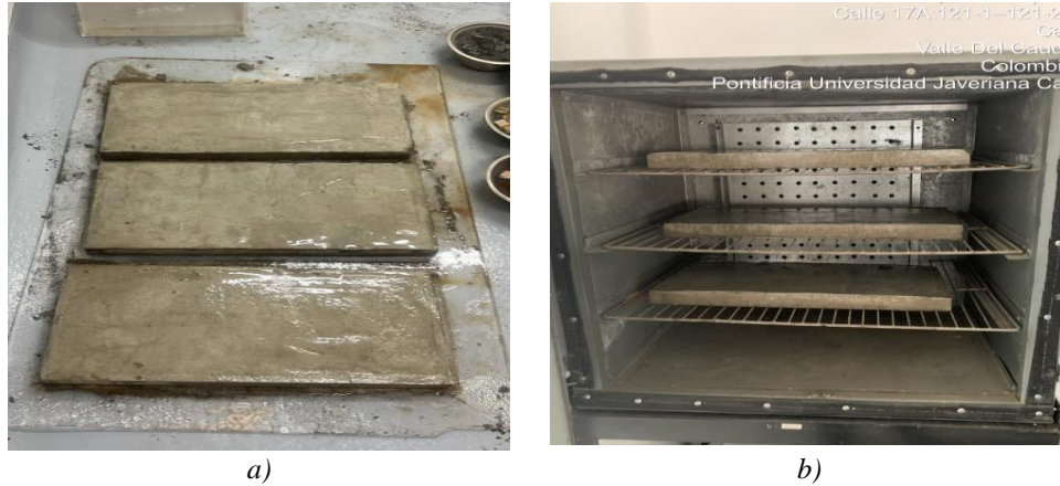
Figura 14. Placas de mortero: a) fundición y curado y b) secado en horno a 50°C.
