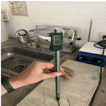
Figura 19. Construcción de la placa P2 (inducción de fisuras): a) medición de profundidad b) fisuras finalizadas
