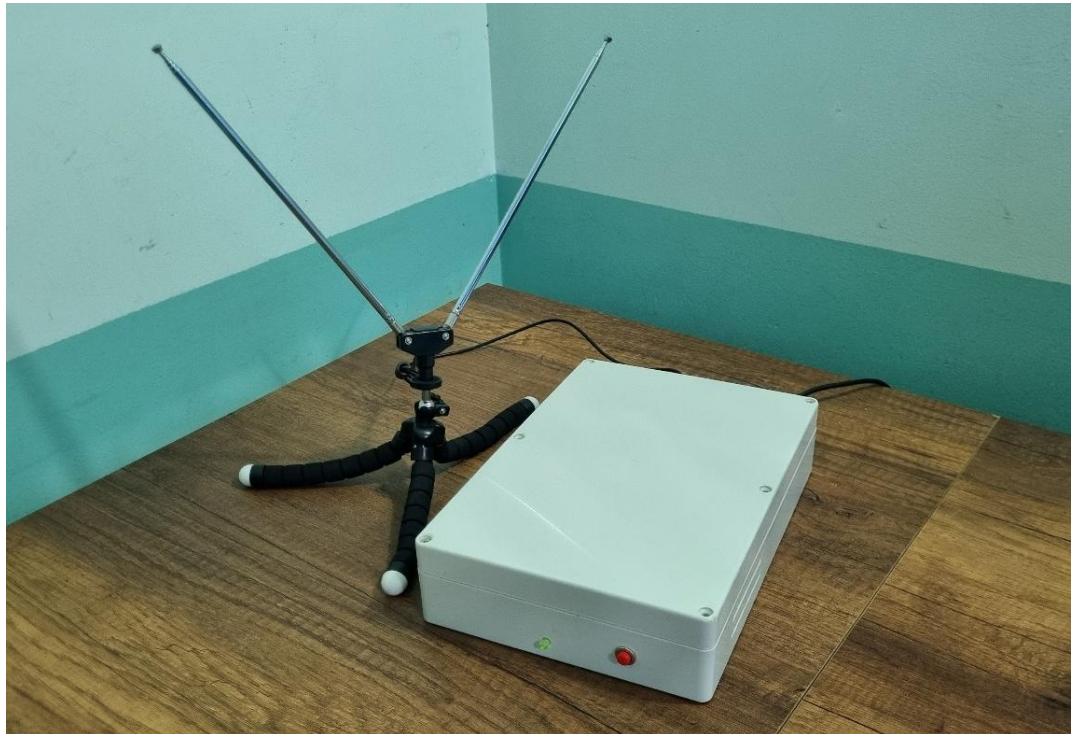
Figura 16. Sistema completo de monitoreo: gabinete, antena y alimentación.
