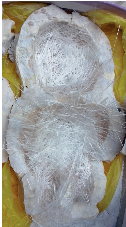
Imágen 50. cubrir con una capa de fibra de vidrio por todo el molde.
