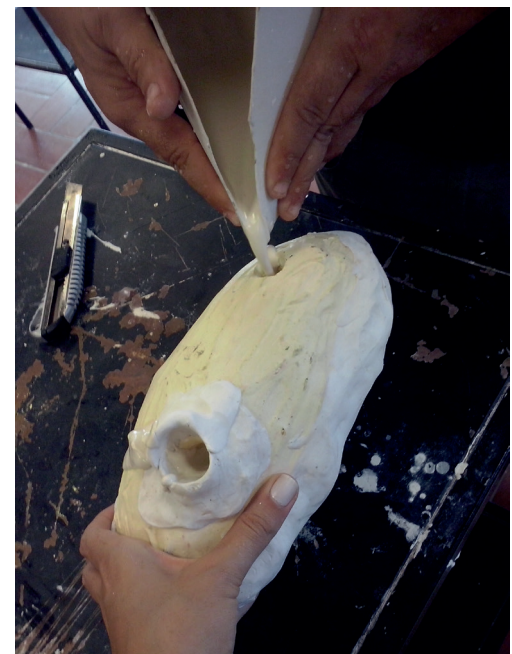
Imágen 47. Vaceado del molde con mezcla de 80% yeso de moldeadura y 20% yeso de dentistería #3.
