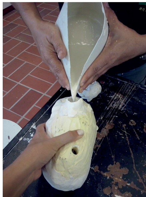
Imágen 46. Vaceado del molde con mezcla de 80% yeso de moldeadura y 20% yeso de dentistería #3.
