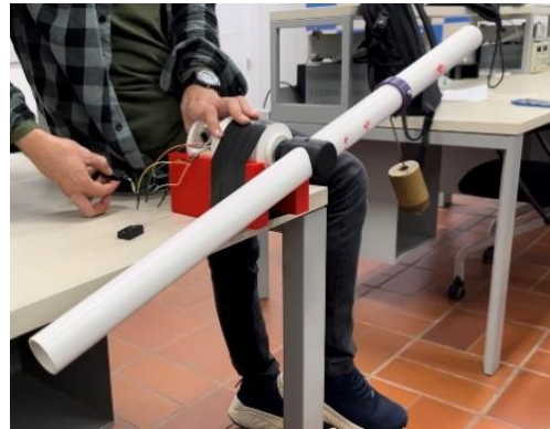
Figura 27 – Prueba de torque de 20 kg-cm.
