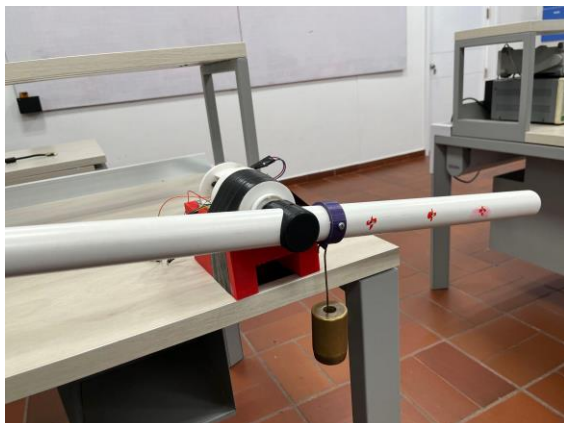
Figura 26 - Sistema con peso acoplado a 5 centímetros.
