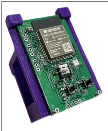
Figura 13 - Porta-baterías con PCB.
