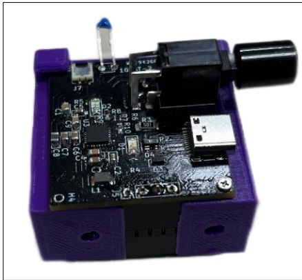
Figura 12 - Porta-baterías con PCB.
