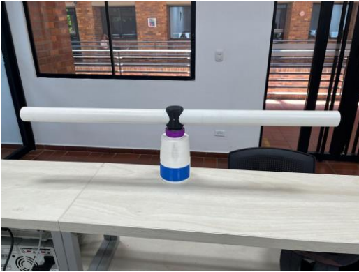
Figura 25 - Efector final diseñado para pruebas de torque.
