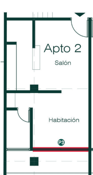
Apartamento 2 P3. Puerta ventana corredera habitación
