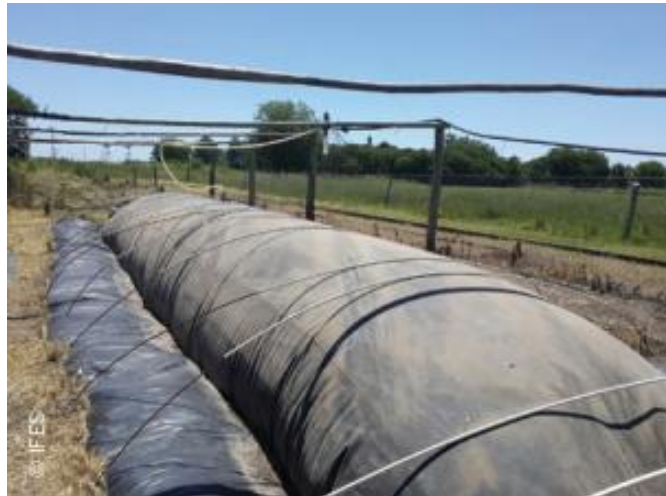
Fig. 16 Biodigestor tubular con membrana de PVC [13]
