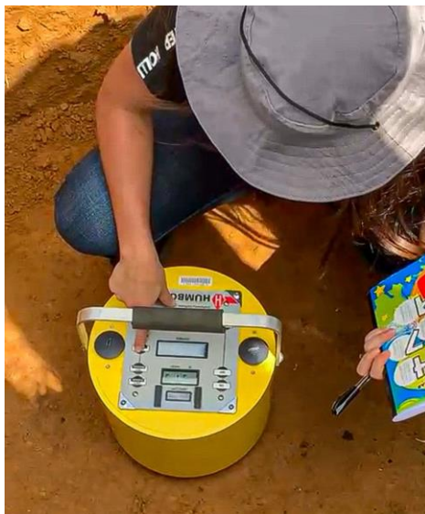
Figura 30. Uso del dispositivo Geogauge.
