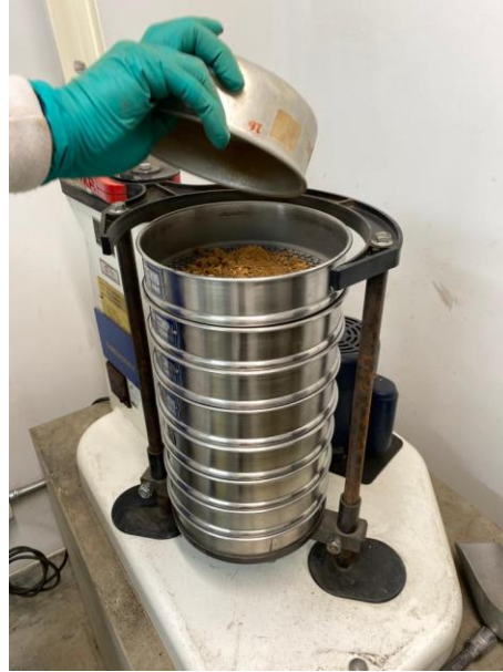
Figura 31. Máquina tamizadora para clasificación de los suelos.
