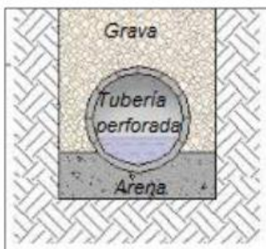
Figura 32. Dren con grava, tubería perforada y arena.
