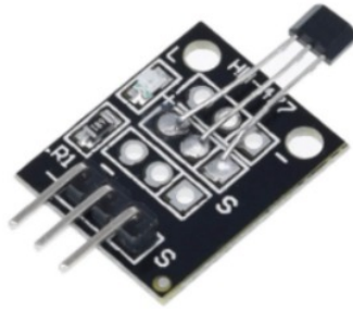
Figura 6.4: Sensor de efecto Hall Fuente: Electronilab
