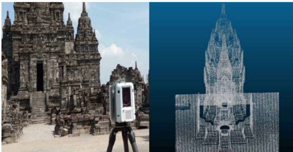
Figura 2.7: Sensor LiDAR (izquierda) generando nube de puntos (derecha) del Templo Sewu, ubicado en Indonesia [Fir21].
