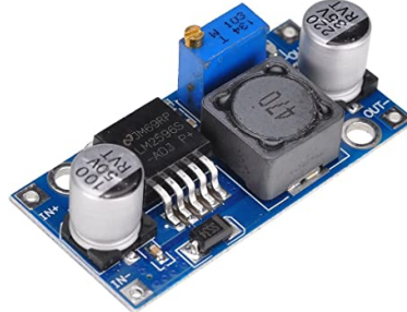
Figura 2.17: Modulo regulador - convertidor DC-DC ideal para sensores y microcontroladores [47].
