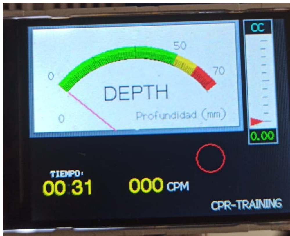
Figura 3.13: Indicadores implementados en el microcontrolador Prototipo CPR-TRAINING #1.
