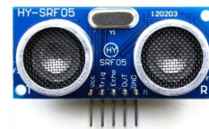
Figura 2.8: Sensor Ultrasónico HY-SRF05 vista frontal
