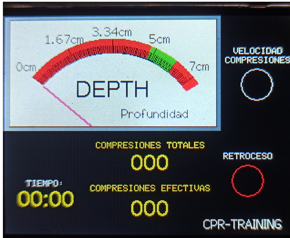
Figura 3.19: Indicadores implementados en el microcontrolador Prototipo #2 CPR-TRAINING.
