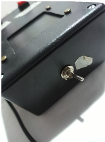
Figura 3.28: Interruptor ON/OFF parte superior caja del proyecto
