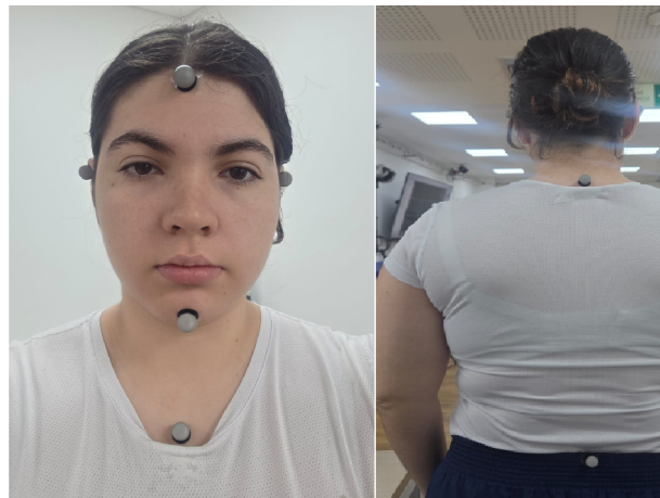
Figura 4: Patrón de posicionamiento de marcadores
