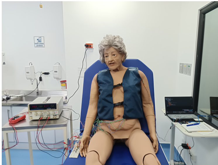
Figura 6.27: Chaleco vibratorio ensamblado cubriendo ambos lados del tórax
