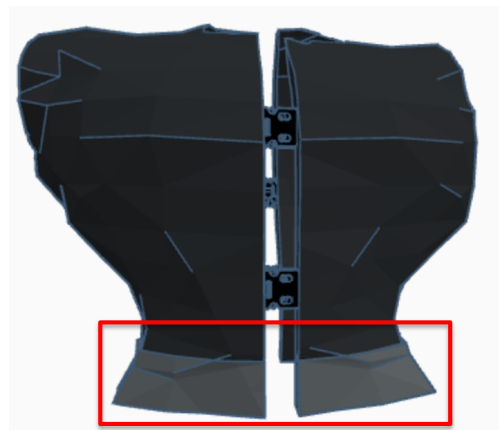
Figura 6.10: Espacio destinado para los componentes electrónicos del prototipo
