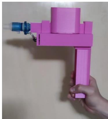
Figura 5.7: Ilustración prototipo de dispositivo de oscilación intrapulmonar. Tomado de [24].
