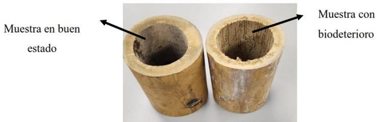
Figura 3 Guadua con y sin biodeterioro
