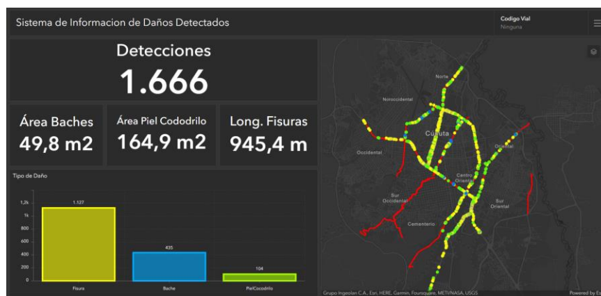
Figura 55. Cuadro de mando daños detectados
