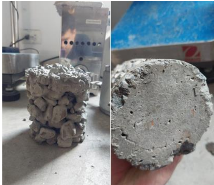
Figura 29 (Ruiz, S;2024) Decantación por pasta muy fluida
