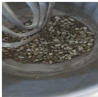
Figura 30 (Ruiz, S;2024) Caso de Mezcla seca y arenosa.
