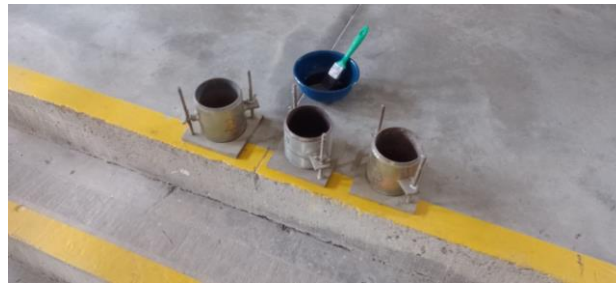
Figura 11 (Ruiz, S;2024) Molde para ensayo Proctor
