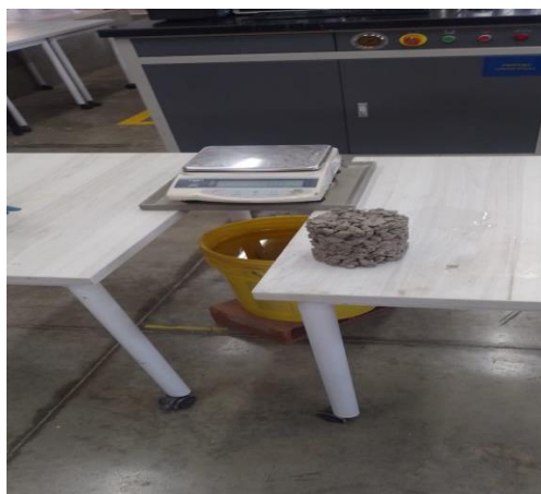
Figura 32 (Ruiz, S;2024) Ensayo de peso sumergido
