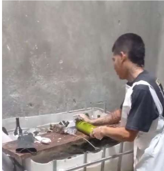
Figura 9. Operario removiendo etiquetas de la botella
