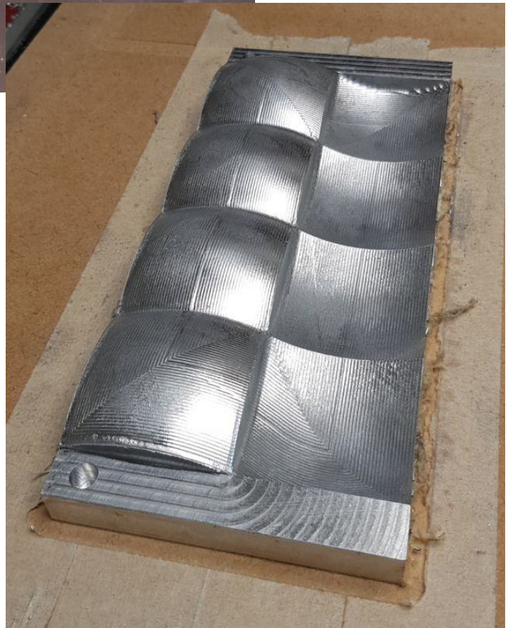
Figura 30. Cama de acero curvada para impresión no plana.
