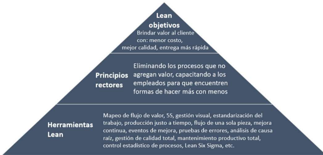
Ilustración 15. Resumen de principios y herramientas Lean, tomado de (Highways England, 2018) y adaptado
