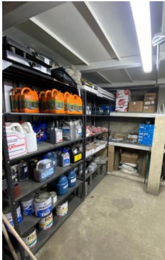
Imagen 3. Ejemplo de implementación de Seiton (Ordenar). Almacén en bodega principal. Fuente: Propia.
