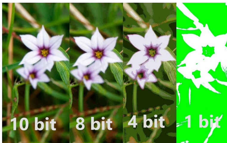
Figura 2.6: Los colores para representar la imagen tendrán una mayor variedad entre más bits tenga un píxel. De derecha a izquierda los bits aumentan por lo que los colores se aproximan a la escena real. Fuente: https://hardzone.es/2018/04/22/profundidad-de-color-pantallas/
