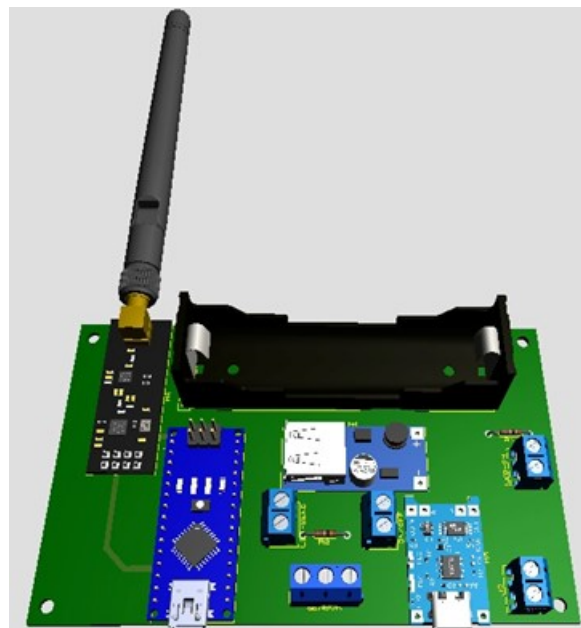
Figura 7.2: Modelo 3D de la PCB del nodo sensor
