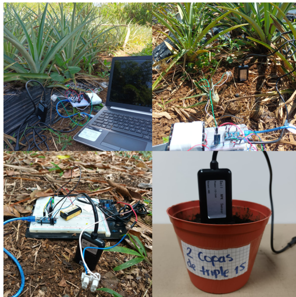
Figura 4.8: Medición de NPK en diferentes muestras de tierra.
