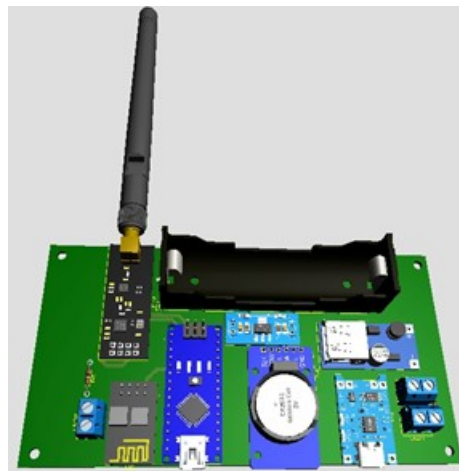
Figura 7.4: Modelo 3D de la PCB del nodo Gateay
